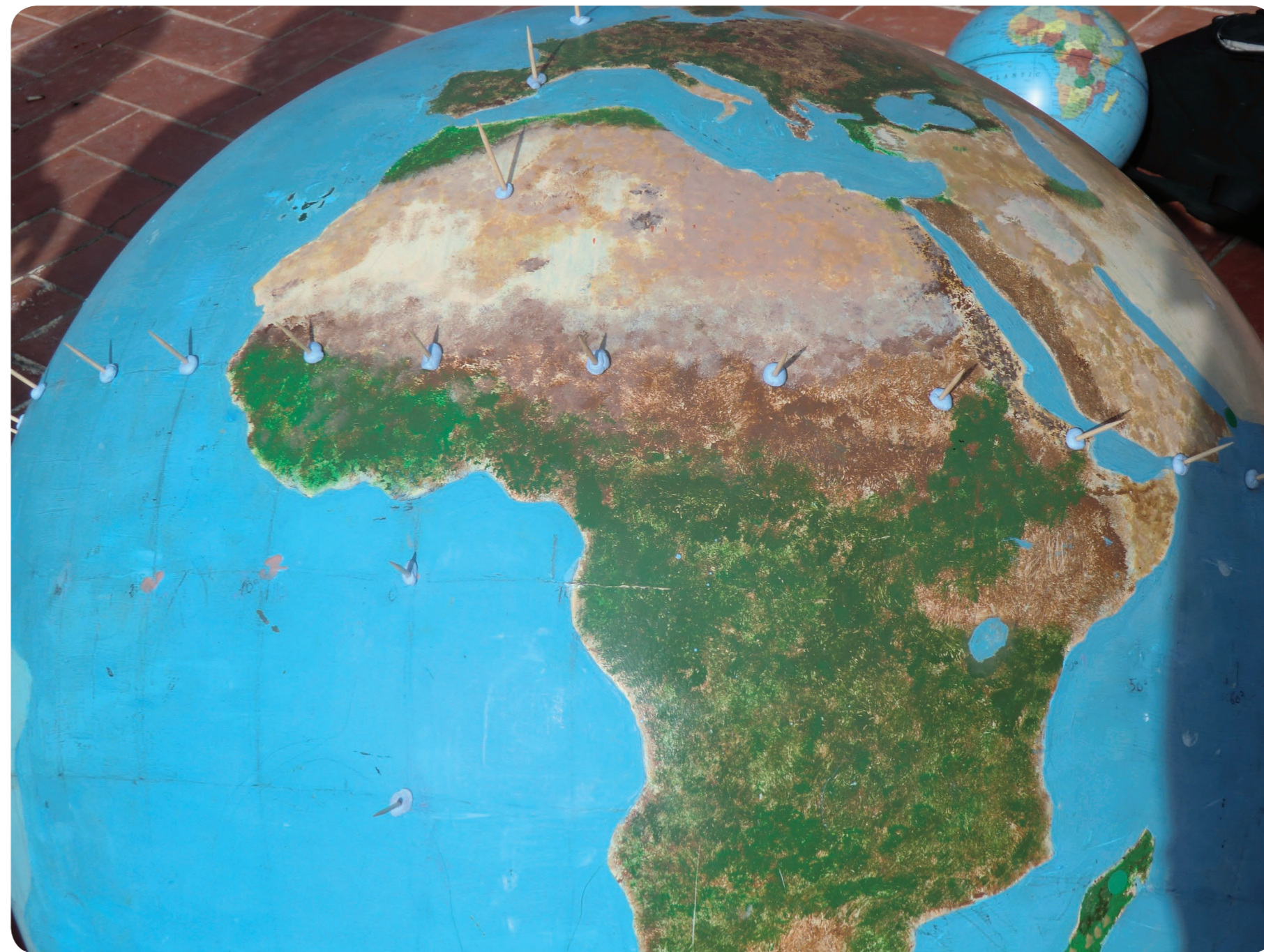
Foto 22: Los gnomons a lo largo del ecuador. Algunos tienen la sombra hacia la derecha y otros hacia la izquierda.
