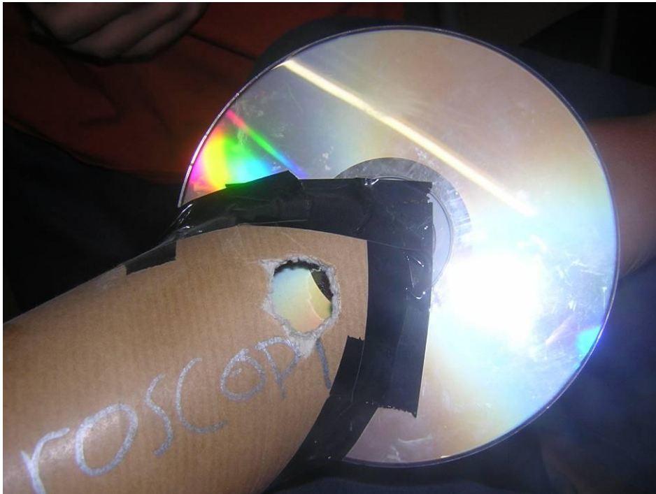
Fig. 5: Detalle del espectroscopio
