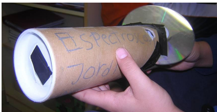
Fig. 4. Espectroscopio con un tubo de cartón.
