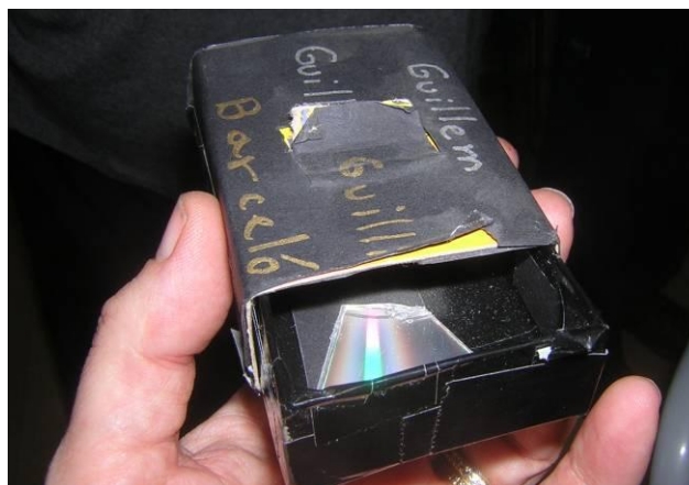
Fig. 1 Espectroscopio de caja de cerillas
