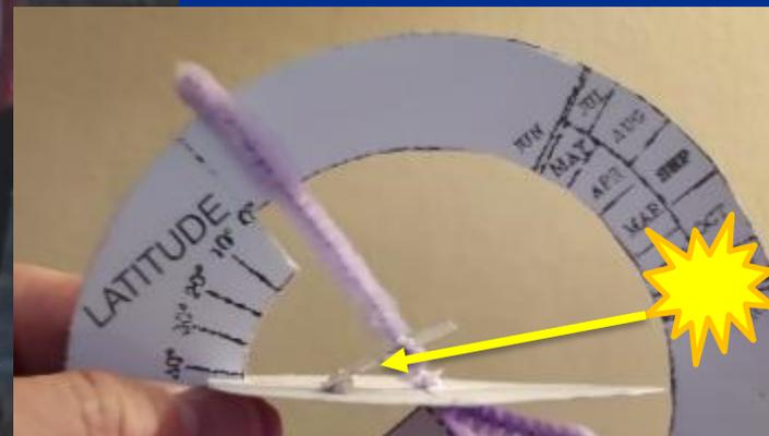
O plano do relógio de sol é paralelo ao equador e o gnomon está de acordo com o eixo de rotação da Terra.
