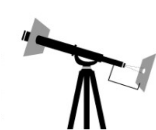
Fig. 10a: Observação solar por projeção com um telescópio (nunca olhe diretamente o Sol).
