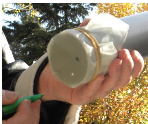
تصویر 12 و 13: دوربین‌های کوچک با سوراخی کوچک برای محاسبه قطر خورشید
