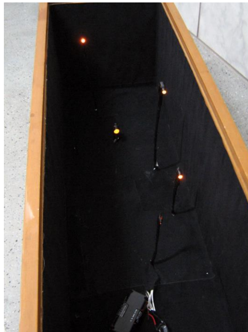
Figura 9: Hastes revestidas com papel preto e com LEDs nas extremidades superiores. Todos foram ligados a uma bateria de 3,0 V.
