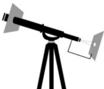
Fig. 10a: Observació solar per projecció amb un telescopi (mai s'ha de mirar directament a el Sol)
